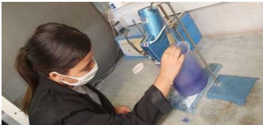
Laboratoire matériaux – Essai au bleu de méthylène
